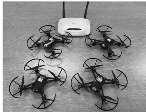
図 6 : 編隊飛行の WiFi 設定 (Station モード)
